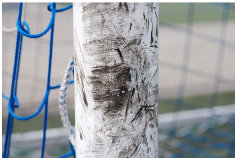
Foto Nr. 6: Verfärbung der Torpfosten durch Gummiabrieb (SBR-Granulat, PU-ummantelt, 5 Jahre alt)
