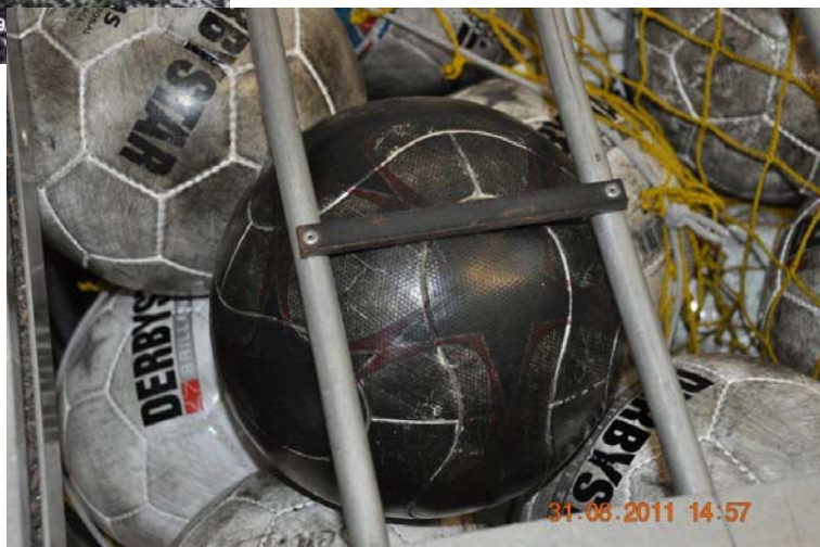
Foto Nr. 4: Verfärbung der Bälle durch Gummiabrieb (SBR-Granulat)
