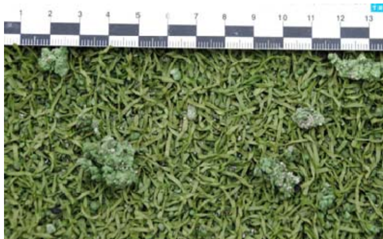
Foto Nr. 7: Verklumptes Peroxyd vernetztes EPDM-Granulat
