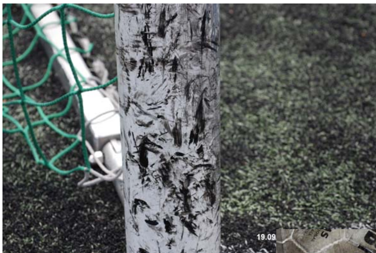
Foto Nr. 3: Abrieb von SBR-Granulat aus Autoreifen auf einem Torpfosten
